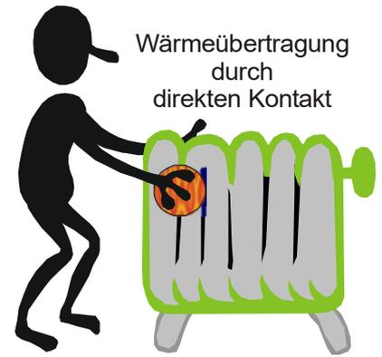
Die Wärmeleitung ist von vielen Faktoren abhängig. Insbesondere von der Wärmeleitfähigkeit des Stoffes. Allgemein kann man zwischen guten und schlechten Wärmeleitern sowie Isolatoren unterscheiden. In der Regel haben Stoffe mit einer hohen Dichte gute Wärmeleiteigenschaften.
