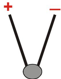
Diese Thermoelemente finden wir bei der Flammenüberwachung und bei unseren Rauch- Abgasanalysegeräten zur Temperaturmessung
