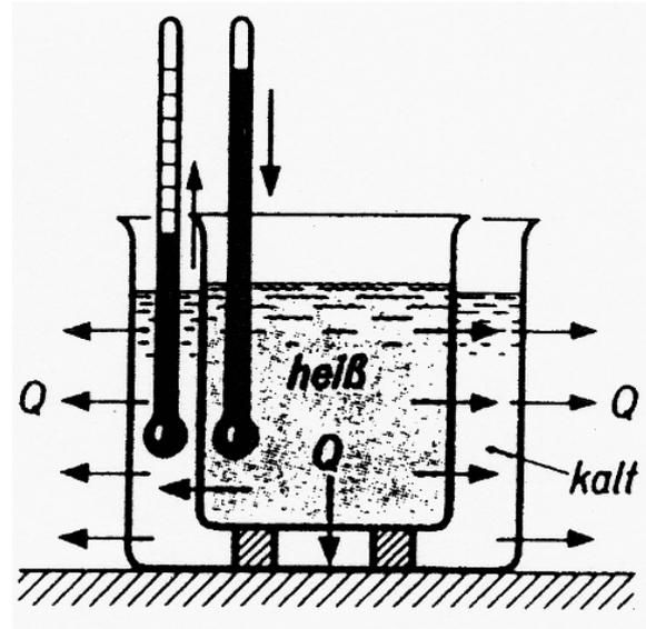
**Wärme ist nicht an einen bestimmten Körper gebunden, sie kann in Richtung der tieferen Temperatur auf andere Körper übergehen. Man nennt diesen Vorgang Wärmeübertragung.**
