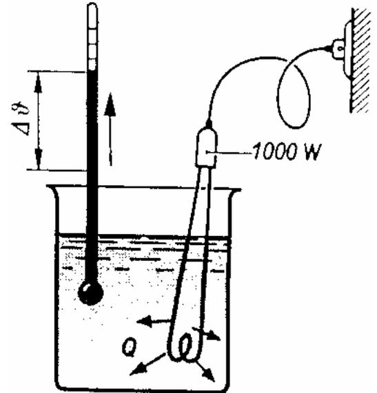
Bei gleicher Wärmezufuhr ist die Temperaturerhöhung von Öl etwa doppelt so groß wie bei Wasser. Die Stoffe erwärmen sich unterschiedlich.
