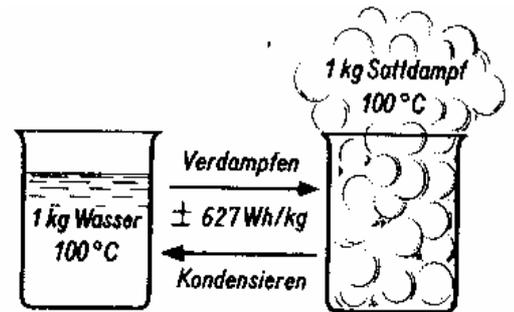
Um Dampf in großen Mengen zu erzeugen, muss einer siedenden Flüssigkeit weiter Wärme zugeführt werden.
